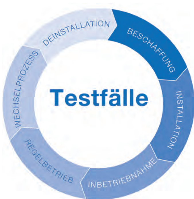
Bild 3: In der von FNN koordinierten Testphase werden Komponenten des intelligenten Messsystems über ihren gesamten Lebenszyklus, von der Beschaffung bis zur Deinstallation, auf Herz und Nieren geprüft
