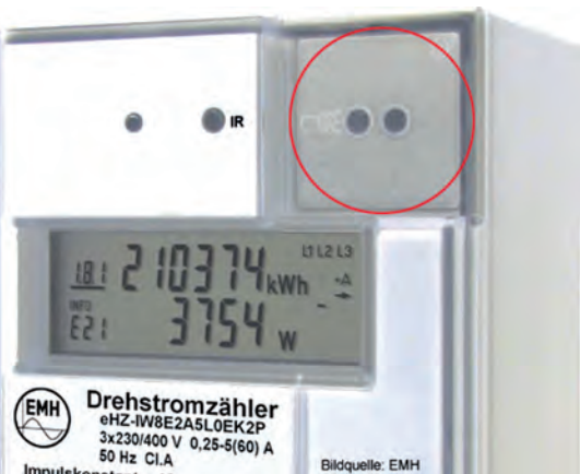
Bild 6: Elektronischer Elektrizitätszähler in Stecktechnik (eHZ) mit aktiver zweiter Displayzeile mit Momentanleistung und Infoschnittstelle
